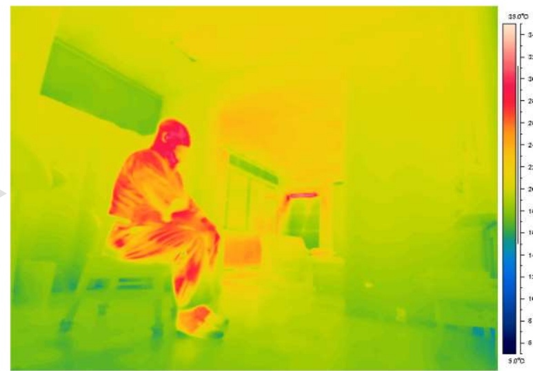
断熱+気密改修後
